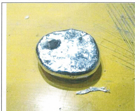
Рис. 10 – частица футеровки, размером 5 мм, внедрённая в алюминий
